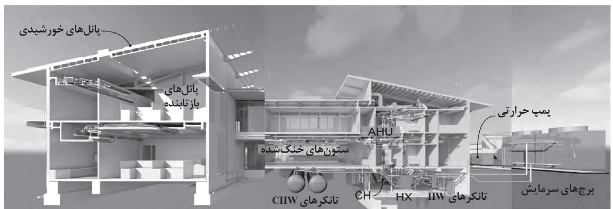
شکل شماره ۱۲- دیاگرام/نمودار سیستم مکانیکی از روی مدل Revit
