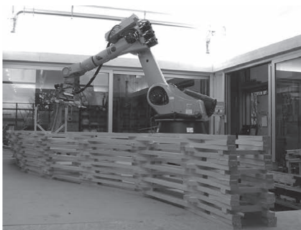
شکل ۴۸- ربات بام‌ساز در حال ساخت سقف چوبی
