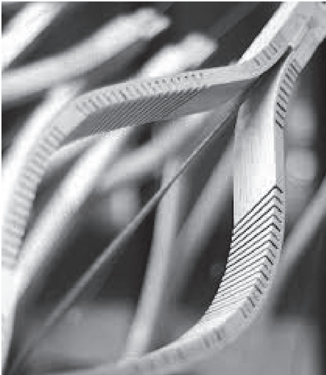
شکل ۳۸- استفاده از روش چاک زدن برای ساخت ماکت‌های چوبی
