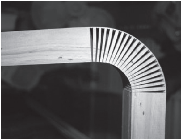
شکل ۳۷- خم کردن چوب به روش چاک زدن
