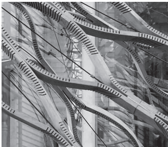
شکل ۳۹- استفاده از ربات برای خم کردن چوب به روش چاک زدن
