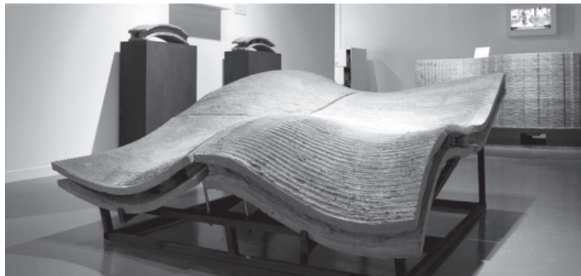
شکل ۲۱- نمونه‌ای از حجم ایجادشده به کمک روش افزودن. در این تکنیک از روی هم قرار دادن لایه‌ها، فرم نهایی به دست می‌آید.
