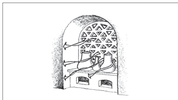
تصویر ۱-۳۴: استفاده از خاصیت برودت تبخیری برای کاهش دمای هوا، با استفاده از اجسام مرطوب
