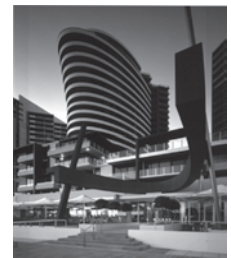
تصویر ۱-۴۷: ضرورت پیش‌بینی گوشه‌های محدب برای جبهه‌ی رو به باد ساختمان‌های مرتفع
