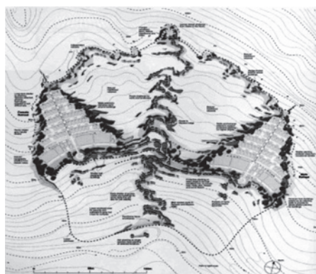
تصویر ۱-۵۸: طراحی محوطه و استفاده از بخش فرو رفته‌ی زمین برای کنترل باد
