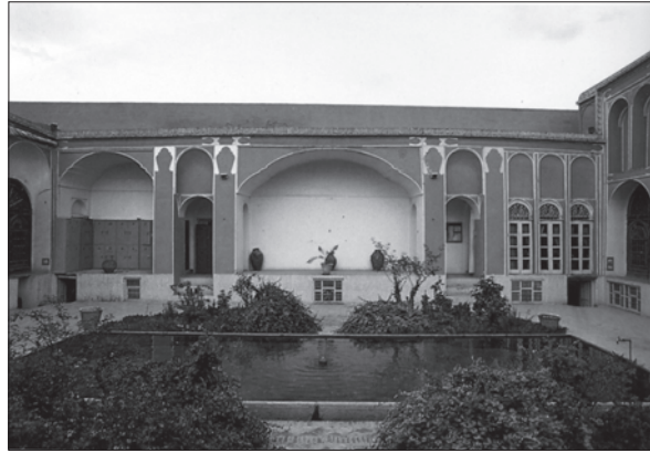
تصویر ۲-۶: استفاده از سطوح پوشیده از آب و گیاه برای تامین آسایش حرارتی
